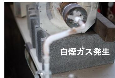
電気炉 A 550℃、電気炉 B 1002℃で反応を確認、多量の白煙ガスを発生
