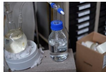
チューブと鋼製蓋接続部を高温耐熱モルタルでシールし洗浄瓶でガス洗浄を試みた
