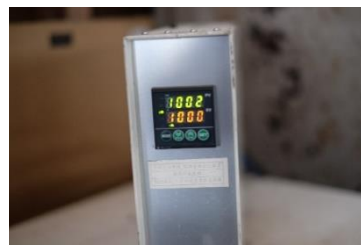
電気炉 A 550℃、電気炉 B 1002℃で反応を確認、多量の白煙ガスを発生
