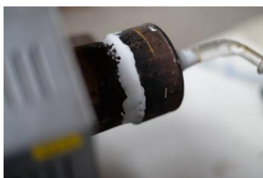
チューブと鋼製蓋接続部を高温耐熱モルタルでシールし洗浄瓶でガス洗浄を試みた
