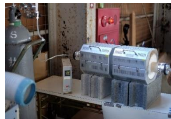
2 台の電気炉間隔を縮めた装置
