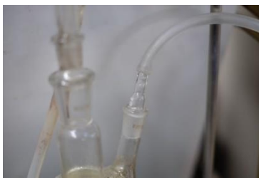
チューブと鋼製蓋接続部を高温耐熱モルタルでシールし洗浄瓶でガス洗浄を試みた
