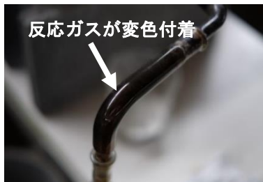
管状電気炉 A 350℃の反応ガス
